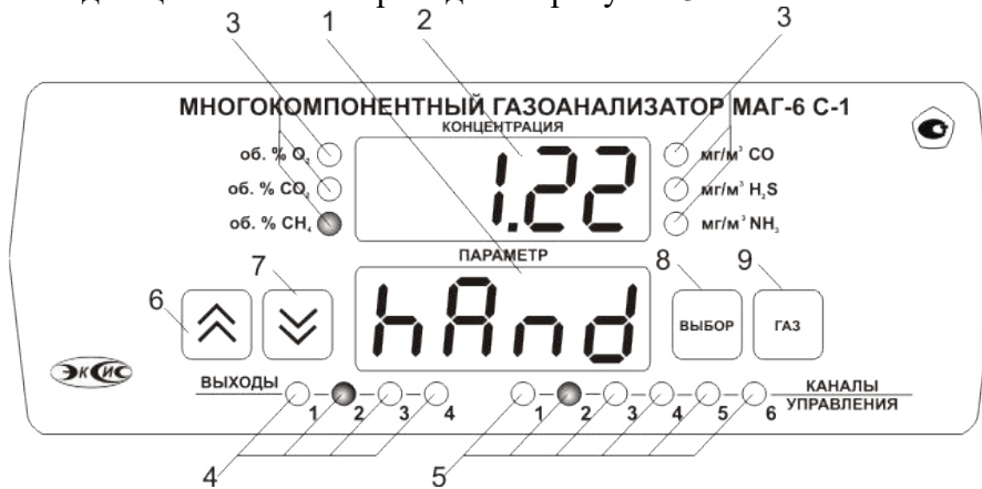
Рисунок 3.1 Вид лицевой панели прибора МАГ-6 С-1
